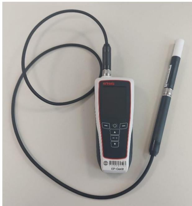
Abbildung 1: Kalibriergegenstand: Feuchtefühler mit Messgerät
